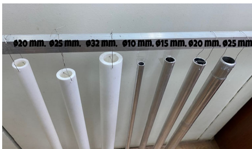
Рис. 1. Объекты наблюдения слева направо: полипропиленовые трубки диаметрами 20, 25, 32 мм и алюминиевые трубки диаметрами 10, 15, 20, 25 мм
