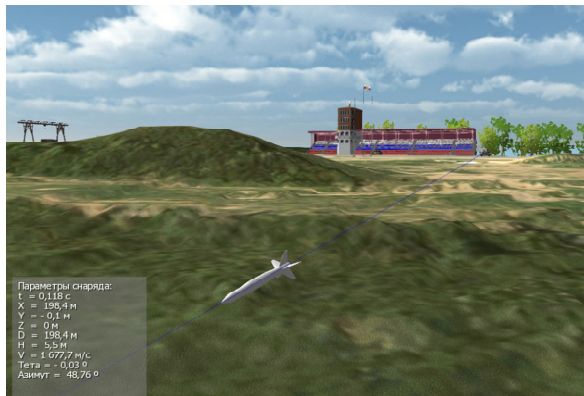
а) отображение траектории движения снаряда на виртуальном полигоне
