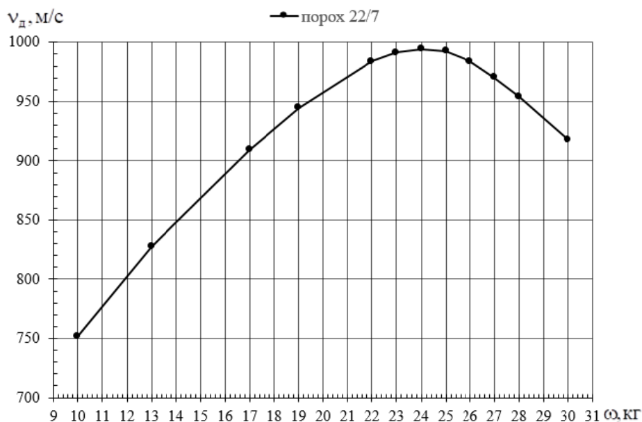
Рис. 1. Зависимость дульной скорости от массы зернового порохового заряда
