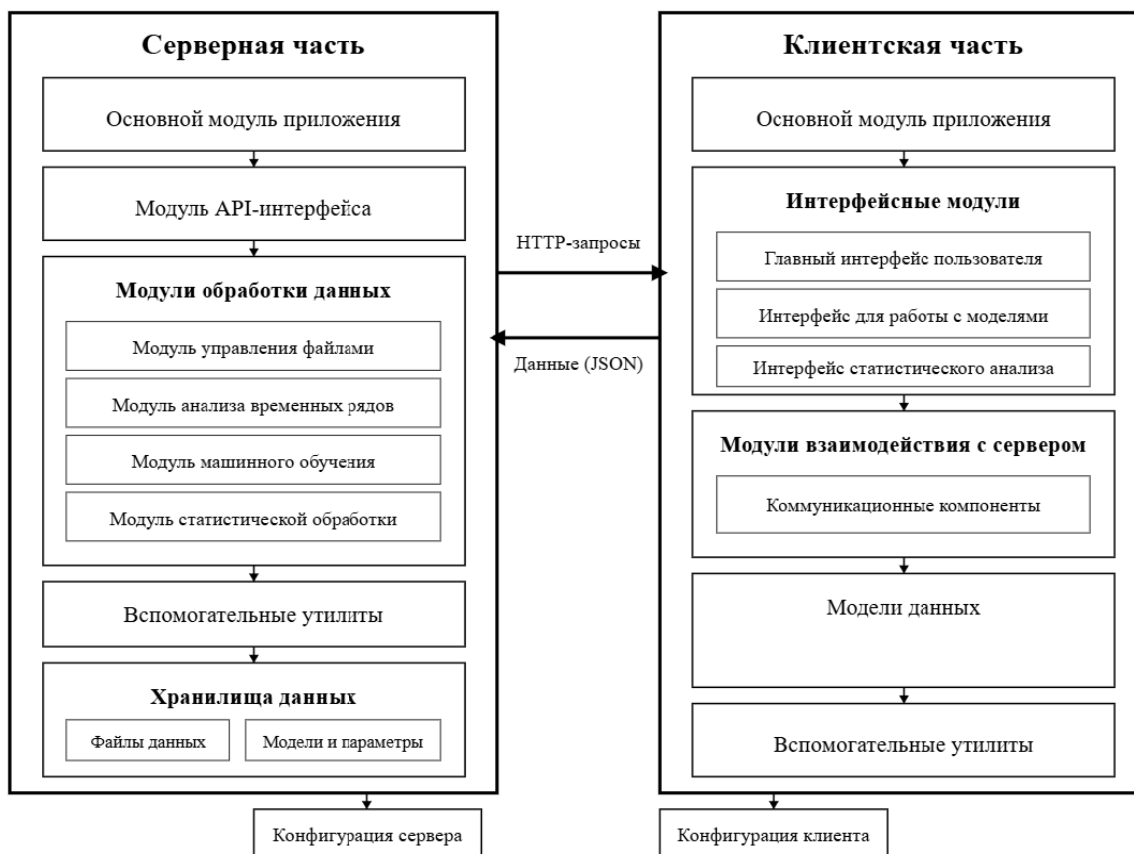
Рис. 2. Архитектура информационно-аналитической системы
